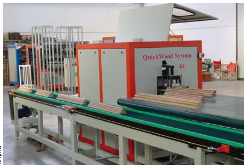
Maszyna szcztokująca QL do profili okiennych z taśmą transportującą.
