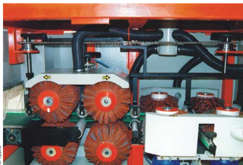
Narzędzie Quick-Disc w maszynie szcztokującej do profili okiennych.
