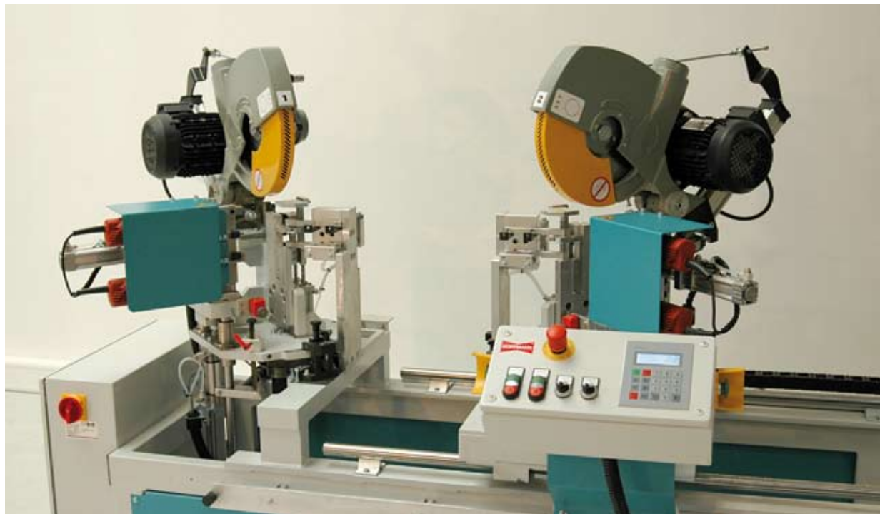
Automat docinający i frezujący Ratio 50 GL obrabia wszystkie rodzaje listew przyszybowych.
