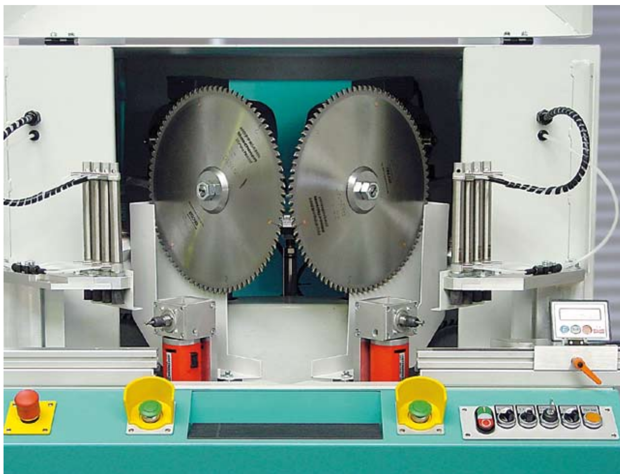
Dwie piły pozwalają na jednoczesne cięcie elementów do połączenia pod kątem.
