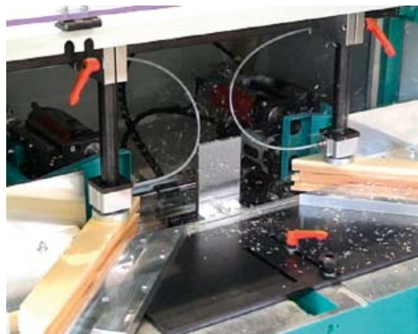
Maszyna obrabia parami dwa elementy w jednym takcie pracy.
