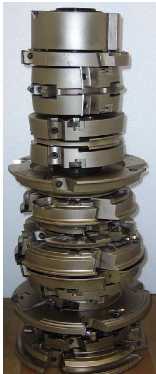
Kolumna narzędzi wzdłużnych na trzpień maszyny o płynnej regulacji wysokości.
