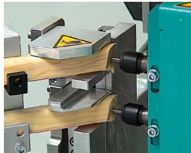
Obróbka listew przyszybowych na maszynie Ratio 50 GL.
