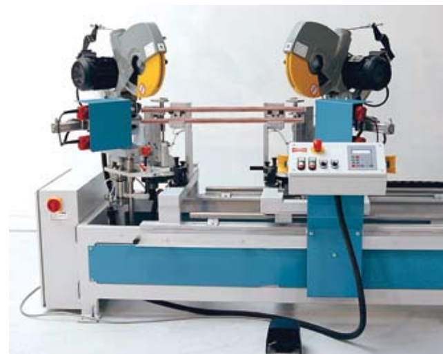
Maszyna HOFFMANN typ Ratio 50 GL z podwójnym stołem roboczym do docinania i frezowania listew przyszybowych.
